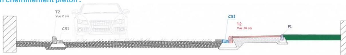
Afin de poursuivre la sécurisation le parcours entre les 62 et 52 de la Route du Canal sera doté d'un accotement de type trottoir avec une bande piétonnière de 1,50m recouverte d'un revêtement poreux. Une bande verte sera maintenue entre les limites de propriétés et ce cheminement.
